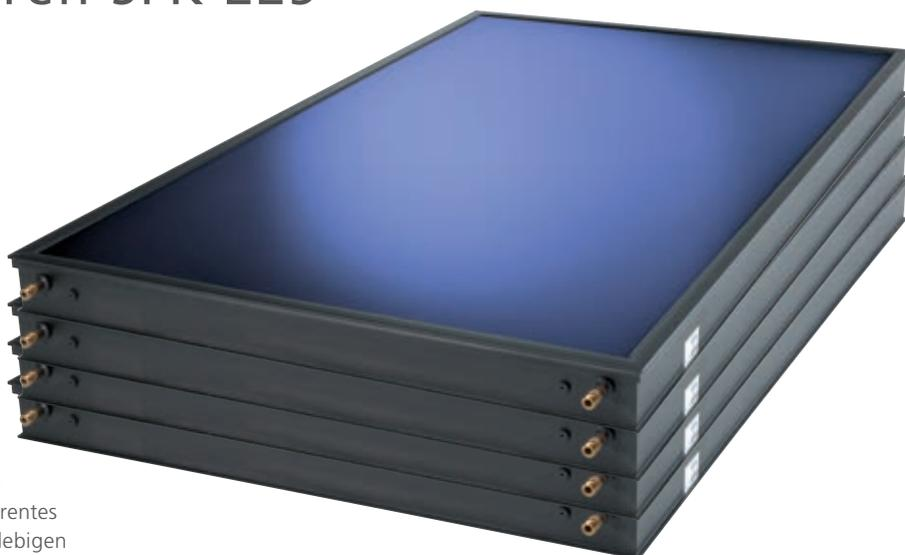
Ein mit dem Absorber verbundenes Doppelharfen-system leitet die entstehende Wärme ab. Der Kollektor wird über Metallwellschläuche und flach dichtende Verschraubungen angebunden. Zur Befestigung stehen ein teilweise vormontiertes Dachmontageset oder Flachdachständer zur Verfügung.
